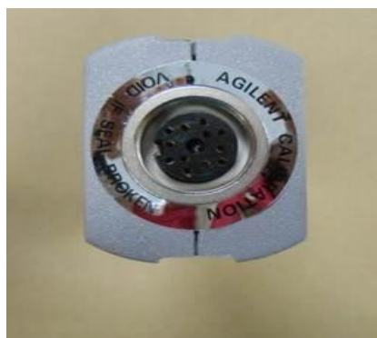
Рисунок 3 – Вид преобразователя измерительного сзади (разъем для подключения кабеля соединительного)
